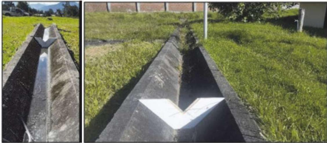
Figura 3. A) Representación de las características del vertedero V-Notch  $90^\circ$  utilizado. B) Imagen con las tres secciones de estudio del canal.
