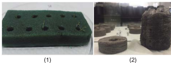
Figura 3. Espuma floral utilizada como medio de soporte (1). Peatmoss en forma de pellets antes y después de la hidratación con SNH (2).
