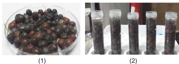
Figura 2. Perlita agrícola utilizada como medio de soporte en caja Petri (1) y en tubos de centrifuga (2).
