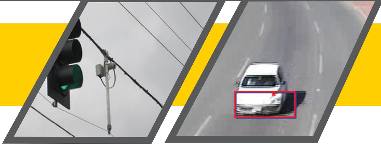
**Figura 3.** Procesamiento de imágenes de video: a) Cámara instalada en los semáforos; b) Detección de vehículos.
