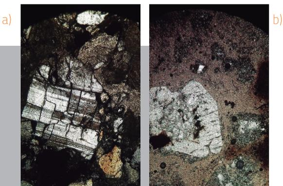
Figura 2. Vista en microscopio en XPL de láminas delgadas de (a) toba y (b) andesita donde presentan matriz vítrea con minerales de cuarzo, plagioclasa y biotita en su mayoría.
