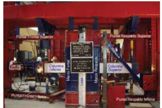
Figura 3 Vista global del dispositivo de pruebas.
